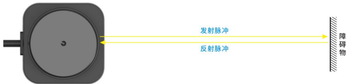
图 2-1 LDS-E300-E 工作原理图
